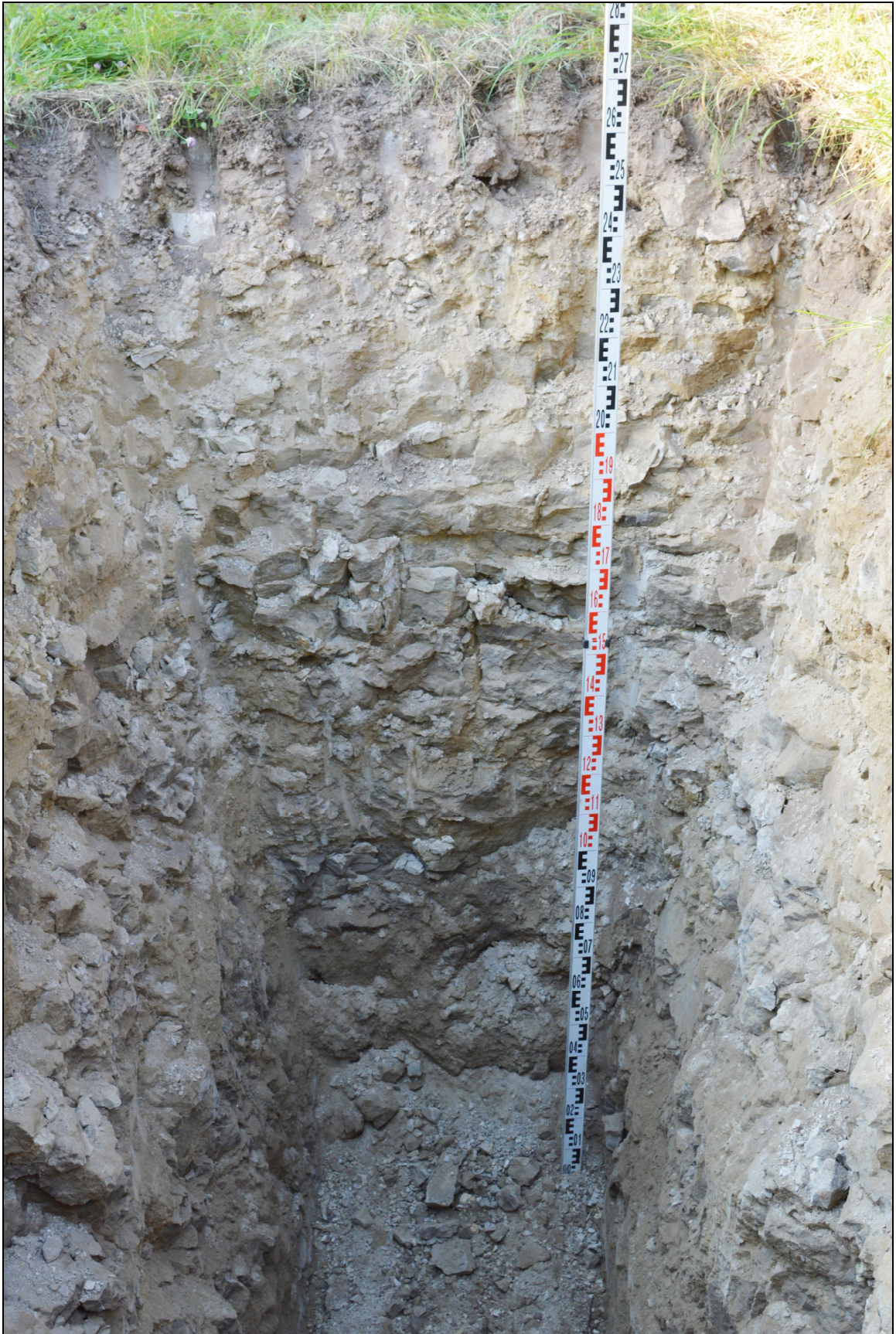
Foto 3: Versickerungsschurf S 3: Dünn- bis maximal mittelbankiger Trigonodusdolomit bereits ab \pm 0,3 m u. GOK. Ab 2,5 m u. GOK war der Dolomitmfels mit 8 to-Bagger und Anbaumeißel praktisch nicht mehr lösbar (Foto: HTR, 27.08.2016)
